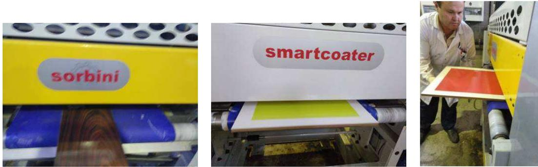
Figura 58. Aplicación de los productos en máquina de rodillos laserroller en la planta piloto de acabados de AIDIMME.
