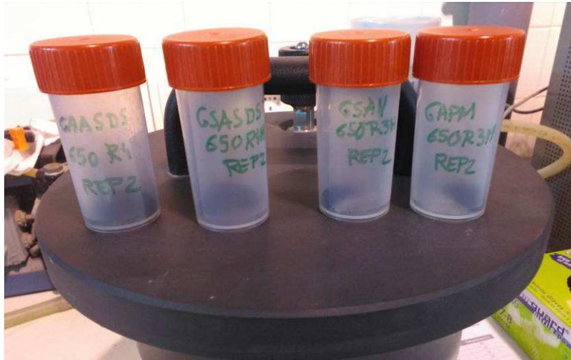
Figura 52. Muestras de grafeno secadas por liofilización
