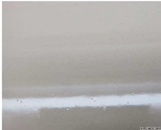
*Figura 53. Detalle de los pinchados en un recubrimiento obtenido con grafeno*
