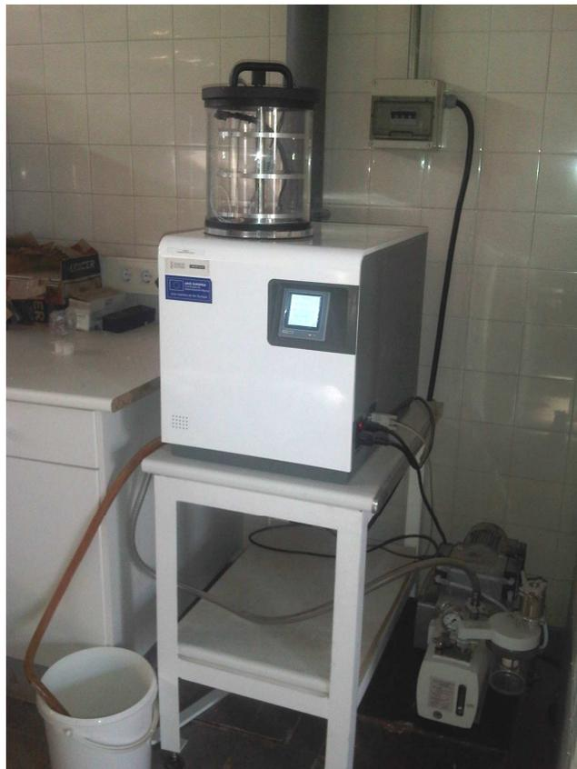
Figura 51. Imagen del liofilizador Lyoquest de Telstar.
