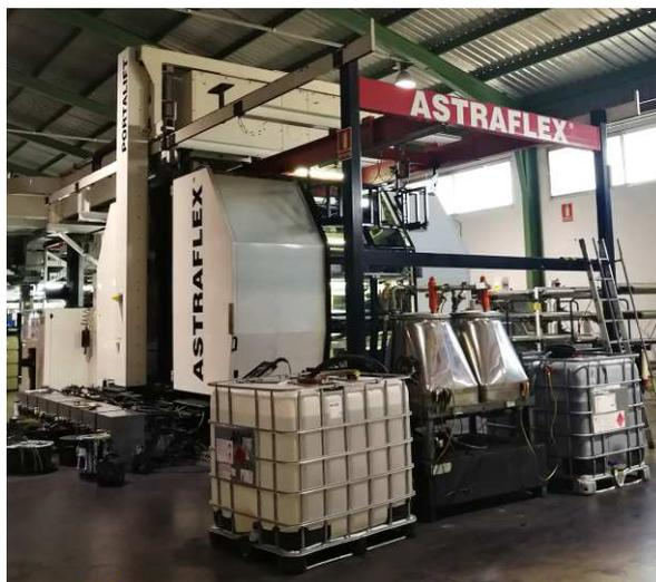
Figura 75. Impresora flexográfica utilizada en la prueba piloto.
