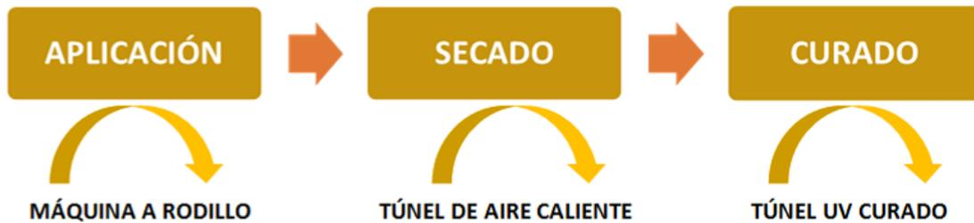
Figura 19. Esquema de aplicación, secado y curado de los productos preparados.
