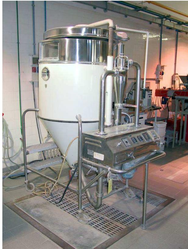
Figura 50. Equipo de laboratorio de secado por atomización Niro.
