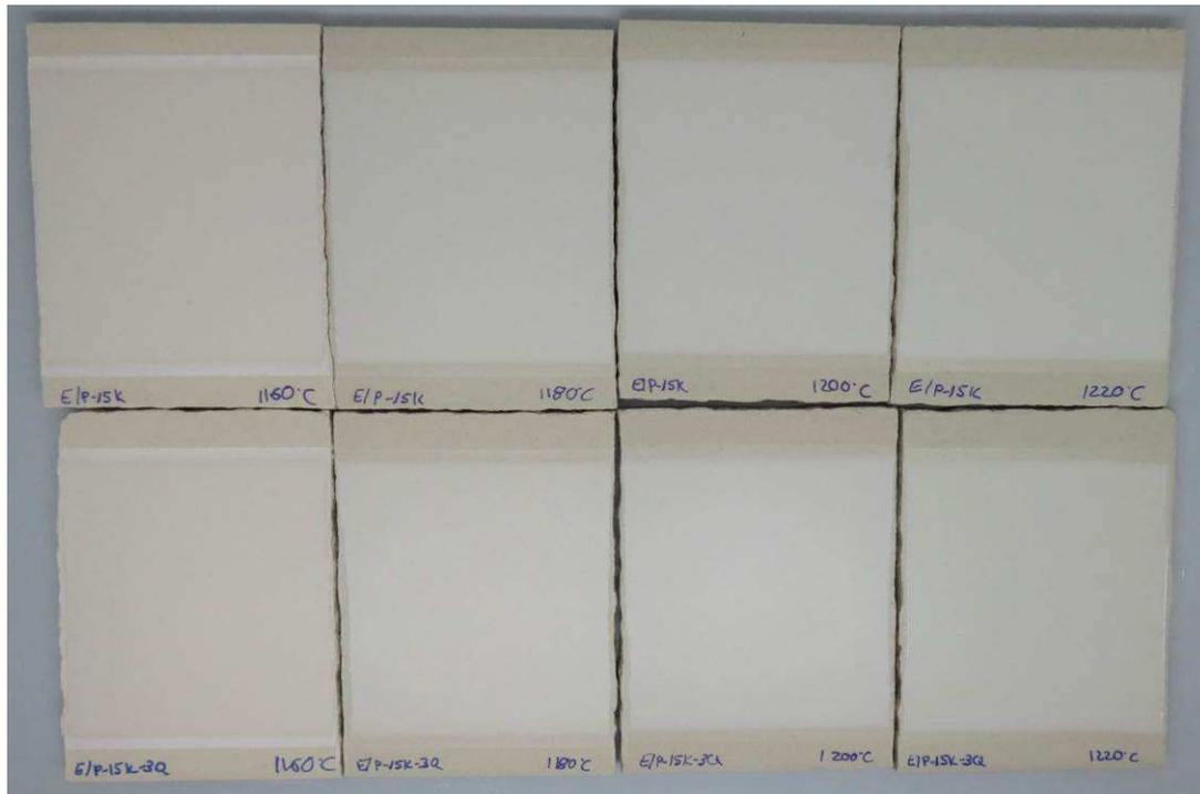
Figura 56. Aspecto de los recubrimientos obtenidos a diferentes temperaturas de cocción
